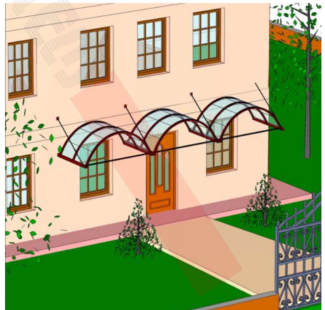
Pensilina Delta A 1 multipli di archi consecutivi di dimensioni e sbalzi variabili
